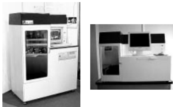
Рис.1. Установки лазерной стереолитографии ЛС-250 (слева) и ЛС-120 (справа).
