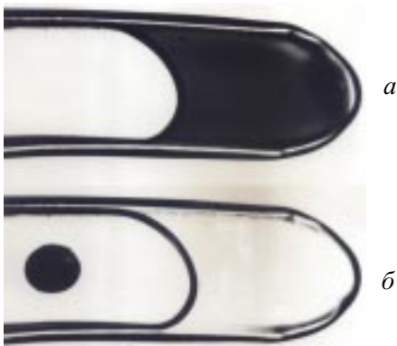
Рис. 9. Кварцевая кювета: a — с раствором йода в ацетоне до облучения; б — после трехчасового облучения лазерным пучком мощностью 0,05 Вт. Масса раствора 0,001 моль, начальная концентрация йода 0,2 мол. %.
