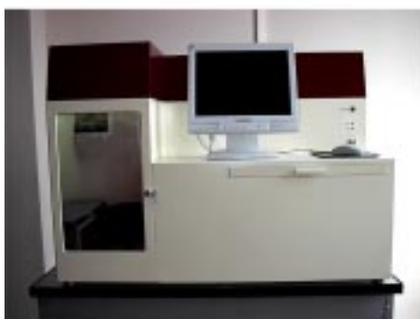
Рис.9. Фотография установки ЛС-120 (слева) и полученные на ней зависимости (справа) толщины отвержденного слоя ( h ) от дозы облучения ( D ) при полимеризации для чистого (1) и ГАП-содержащего ОКМ-2 (2). Получены при мощности излучения P=10 мВт и диаметре лазерного пучка на поверхности ФПК равной 0,12 мм. Доза облучения изменялась путем изменения скорости движения пучка по поверхности ФПК.
