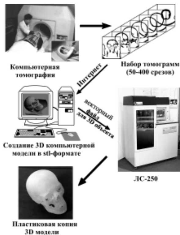
Рис. 6. Схема оперативного изготовления пластиковых биомodelей по результатам исследований пациентов на компьютерных томографах в специализированных клиниках.
