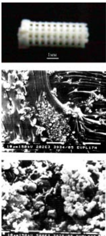
Рис.10. Фотография образца, изготовленного из минерал-полимерной композиции, для имплантации белым крысам (а) и его структура до (б) и после (в) обработки в сверхкритическом CO 2 .
