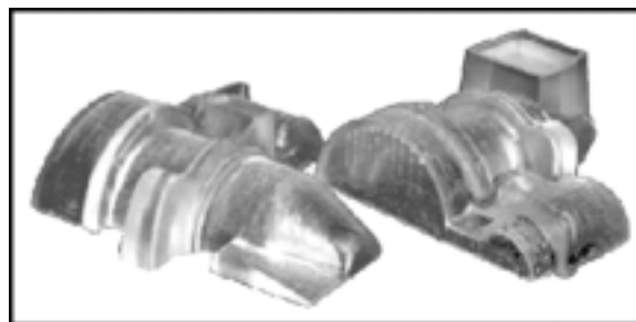
Рис.11. Элементы оснастки изготовленные методом лазерной стереолитографии.
