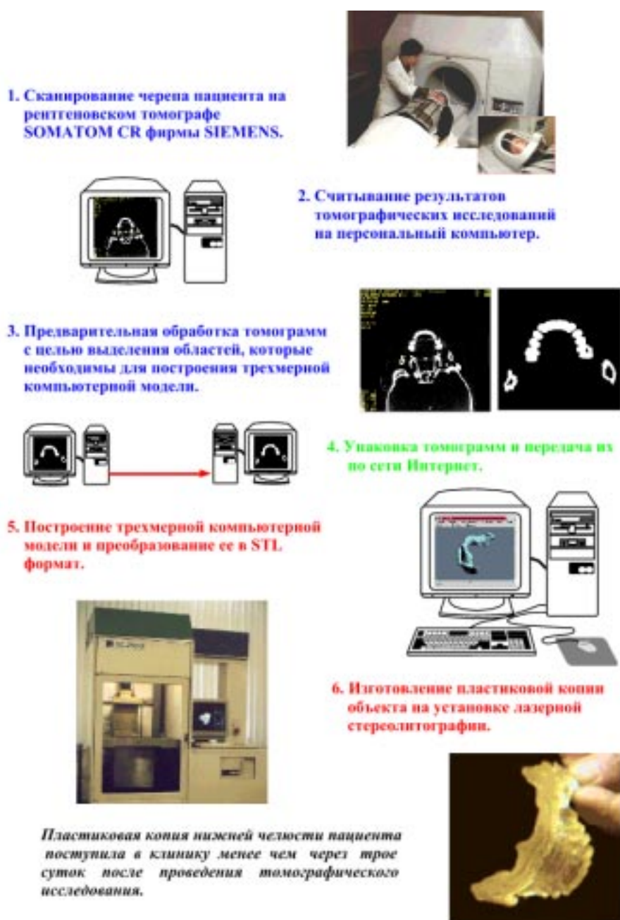
Рис.8. Схема оперативного изготовления пластиковых копий фрагментов черепа пациентов по результатам томографических исследований.
